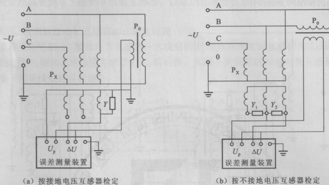
图 4 三相五柱电压互感器误差检验线路
