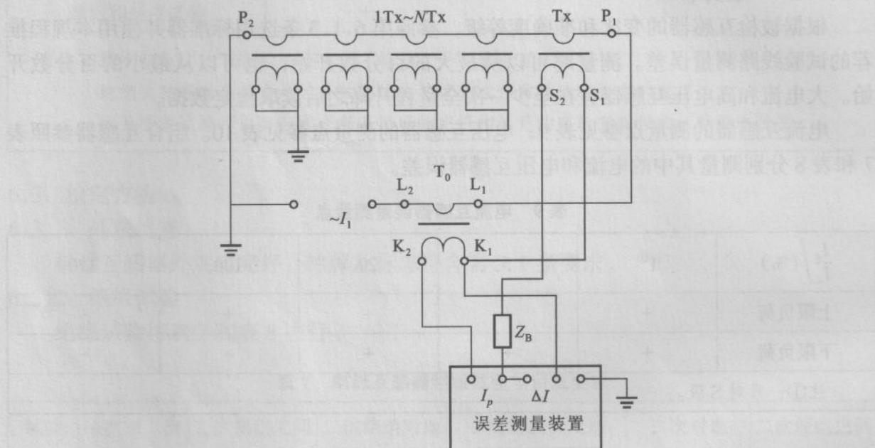
图 1 电流互感器误差测量接线
