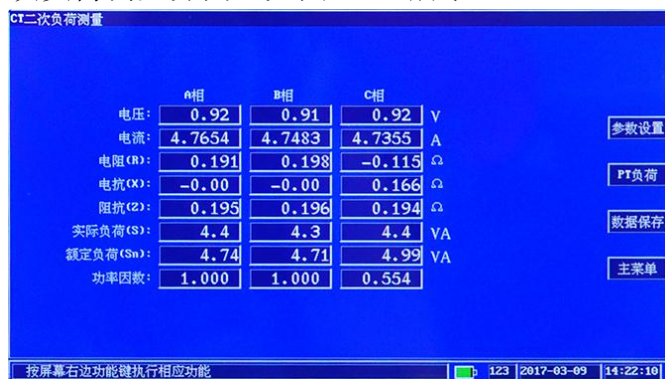
图 14-2 CT 二次负荷测量
