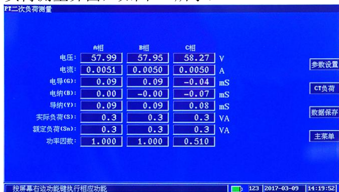
图 13 PT 二次负荷测量
